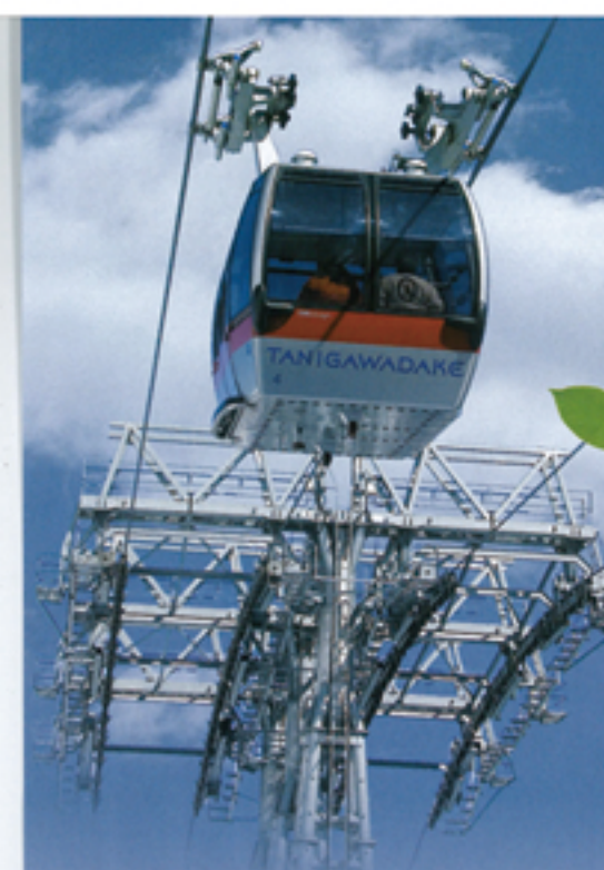
複式単線自動循環式ゴンドラ (通称「フニテル」)
